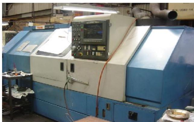
CNC旋盤 ヤマザキマザック H4年製
