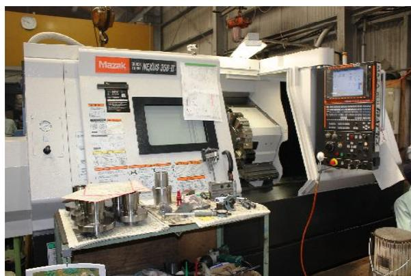
CNC旋盤 ヤマザキマザック製
